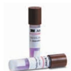
Биологические индикаторы Attest для паровой стерилизации представляют собой полоску со спорами, помещенную в пластиковый пенал, содержащий запаянную стеклянную ампулу с питательной средой и чувствительным красителем. Действие биологических индикаторов заключается в том, что они определяют не просто соблюдение технических нормативов
