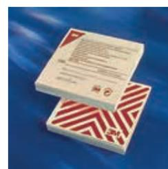
Данный вид химических индикаторов используется в паровых стерилизаторах форвакуумного типа для выполнения теста Боуи-Дика. Тест-пакеты состоят из индикаторного тестового листка и двух пачек бумажных листов, либо материалов различной плотности (артикул 1302BD), которые упакованы в бумажную обертку, закрепленную липкой
